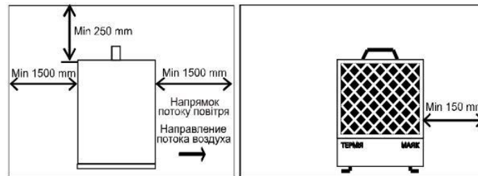
Рисунок 1 Розміщення з урахуванням мінімальних відстаней до найближчих оточуючих поверхонь. Рисунок 1. Расположение с учетом минимальных расстояний до ближайших ограждающих поверхностей
