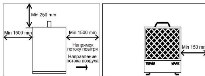
Рисунок 1 Розміщення з урахуванням мінімальних відстаней до найближчих оточуючих поверхонь.
